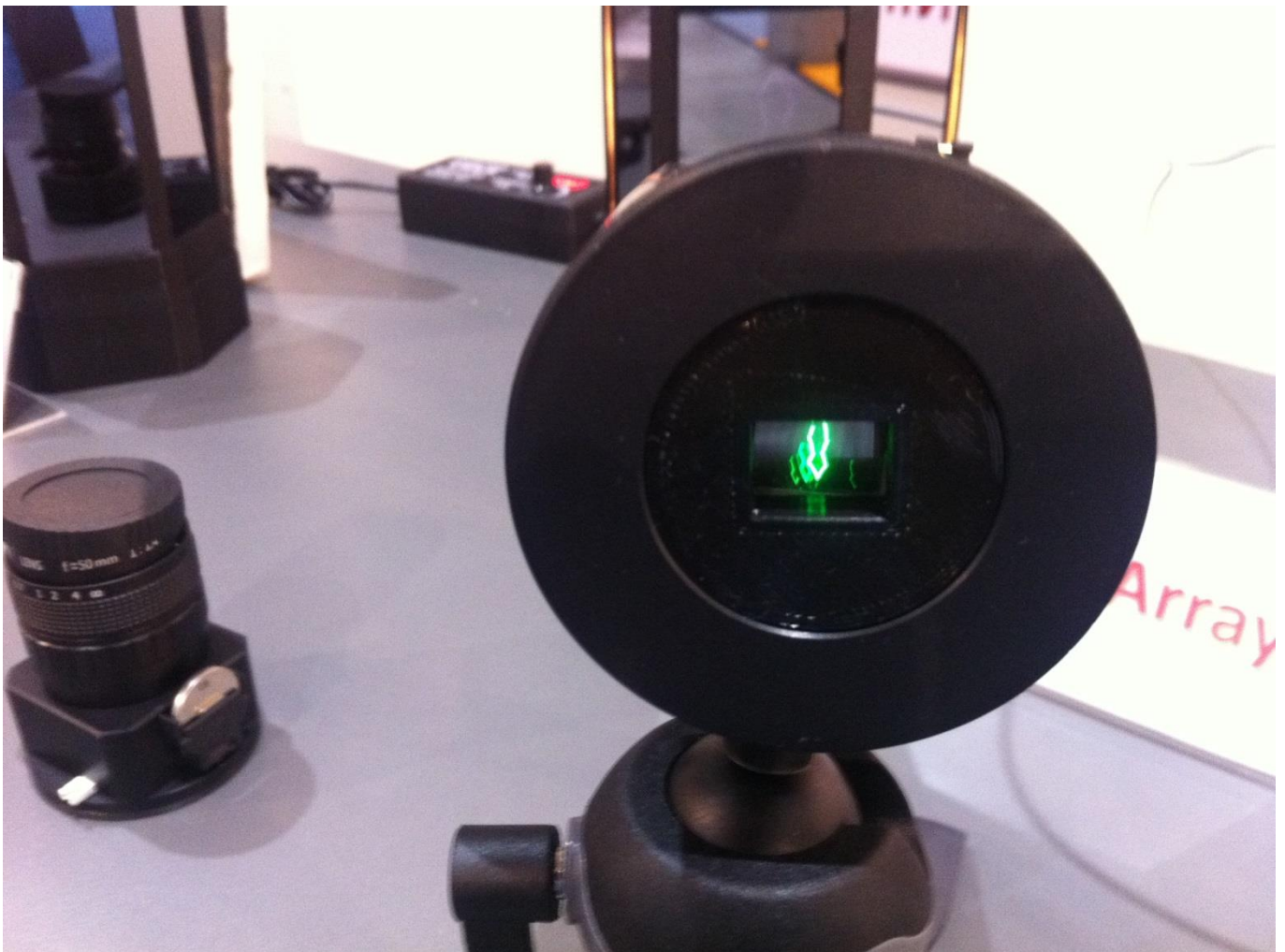
Bild 1 – Darstellung einer Glühwendel mit dem DIRVIEW
