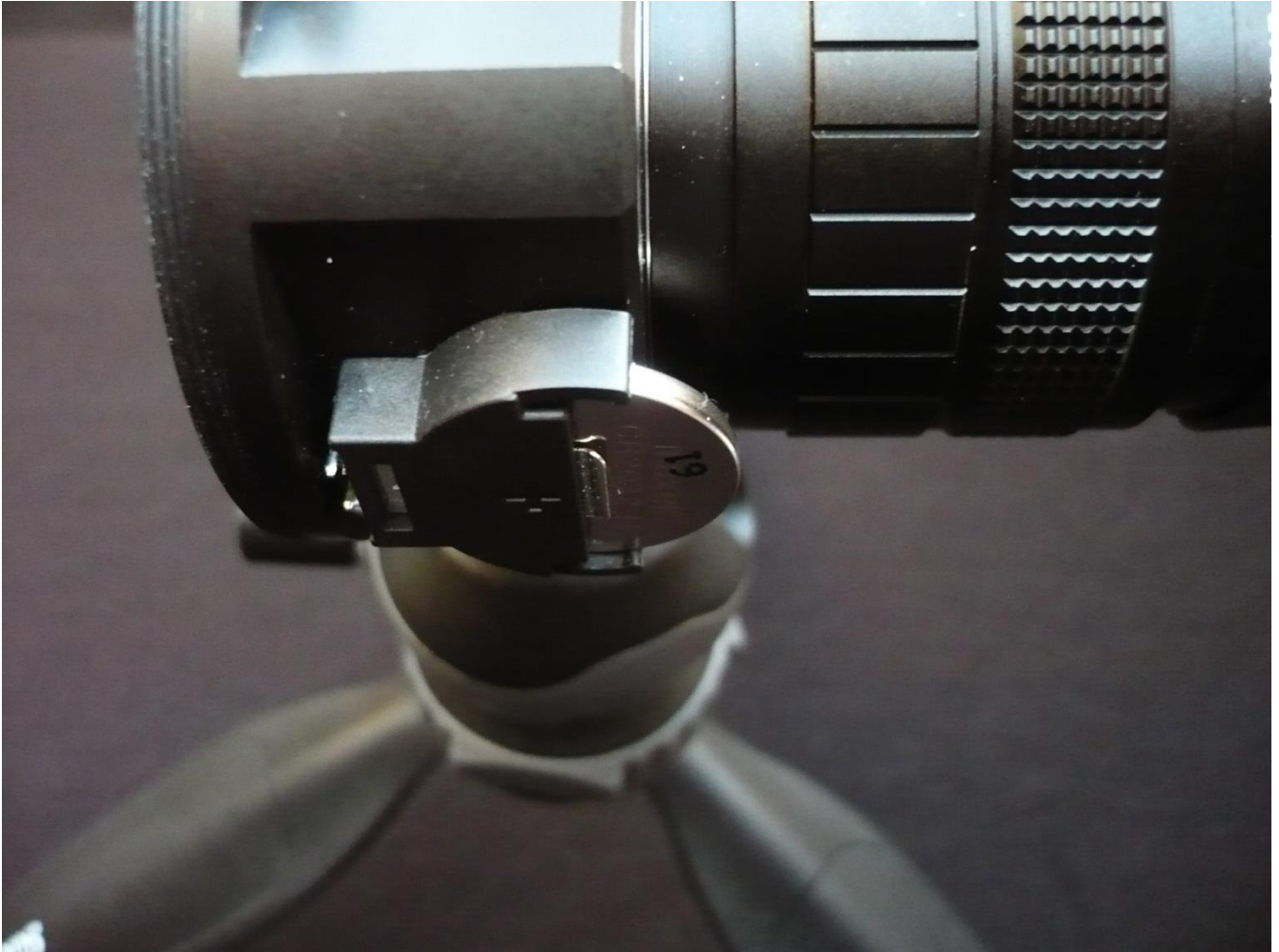
Bild 6 : Batterie der DIRVIEW-Demo
