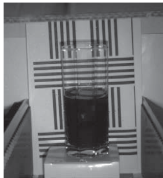
Wasserabsorption bei Lichtwellenlänge 1.300 nm (Laboraufnahme) (Quelle: ABS GmbH, Jena)
